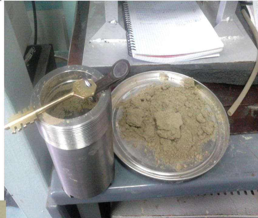
1. Камера высокого давления заполняется смесью кварцевого песка и ледового порошка
