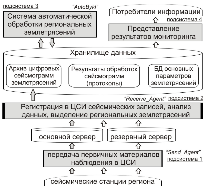
Рис. 2. Архитектура информационно-аналитической системы для мониторинга землетрясений
