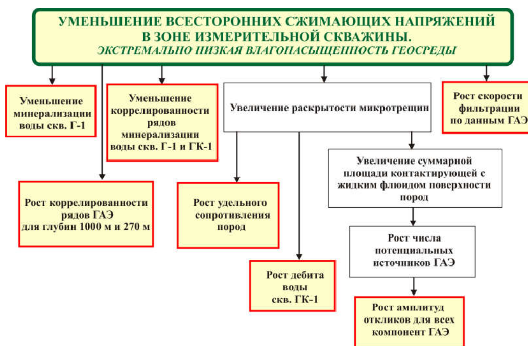
Рис. 16. Тенденции изменений регистрируемых величин при уменьшении всесторонних сжимающих напряжений в случае экстремально низкой влагонасыщенности геосреды
