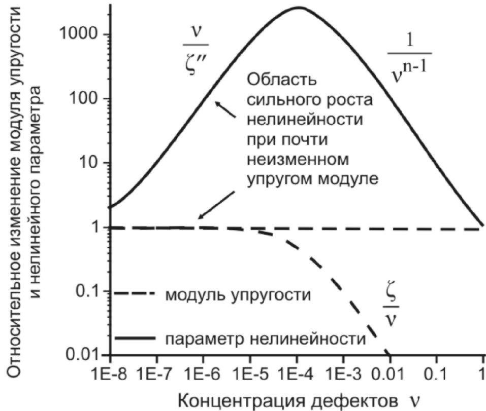
**Рисунок 1.2.** Относительные изменения модуля упругости  $E_{eff}/E$  и параметра квадратичной ( $n = 2$ ) нелинейности  $\gamma_{eff}^{(2)} / \gamma^{(2)}$  микронеоднородной среды, содержащей дефекты с типичным для трещин показателем относительной мягкости  $\zeta = 10^{-4}$ . (Согласно [Зайцев, Гурбатов, Прончатов-Рубцов, 2009]).
