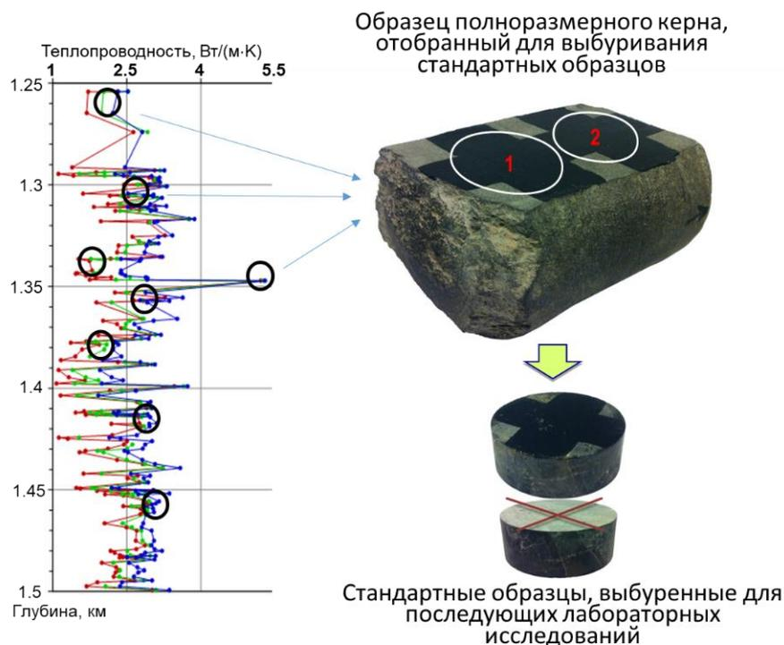
Рисунок 4.35. – Использование теплофизического профилирования для обоснованного отбора образцов полноразмерного керна и их участков для выбуривания стандартных образцов пород для лабораторных петрофизических исследований.
