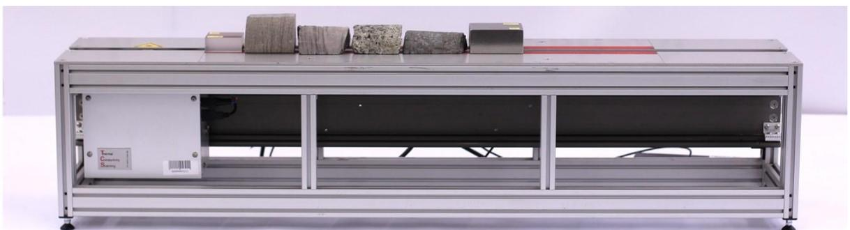
Рисунок 1.4. – Прибор оптического сканирования для измерений тепловых свойств горных пород
