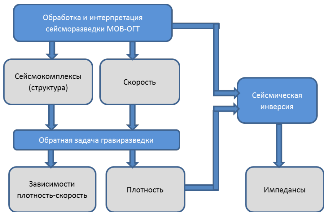
Рисунок 2. Блок-схема процесса комплексной интерпретации данных сейсморазведки МОВ-ОГТ и аномалий силы тяжести.
